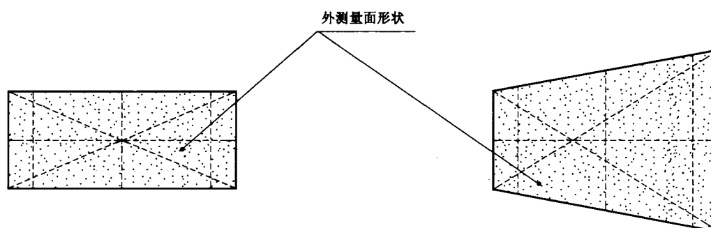
图 B.1 划线量爪工作面平面度的检验方法
